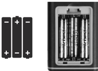
Откройте крышку батарейного отсека на задней части прибора, вставьте батареи, соблюдая полярность, затем закройте крышку.
